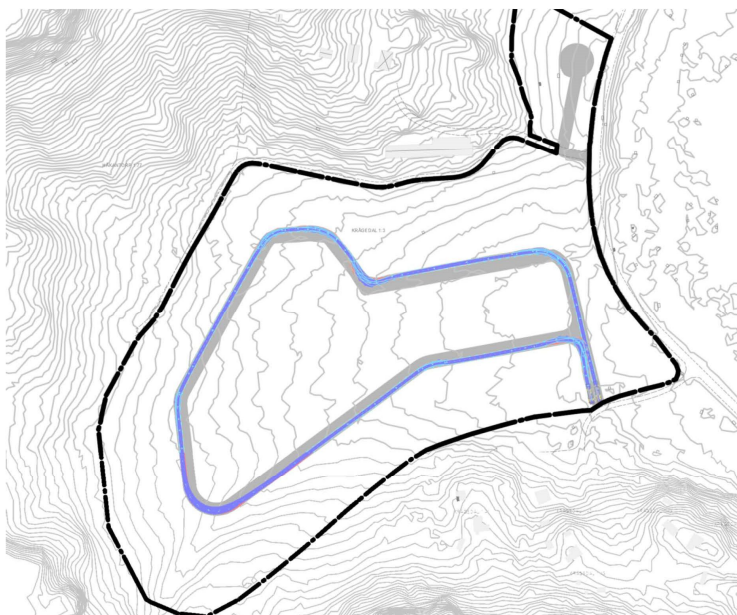
Figur 20. Bild från körstudie. Visar körspåren i blått för typfordon Lbn, exempelvis tunglastbil och normalbuss.
